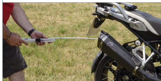
Die Messung der Lautstärke erfolgte mit einem Sound-Level-Meter im Abstand von 0,5 m und in einem Winkel von 45 Grad auf Flüterhöhe.
