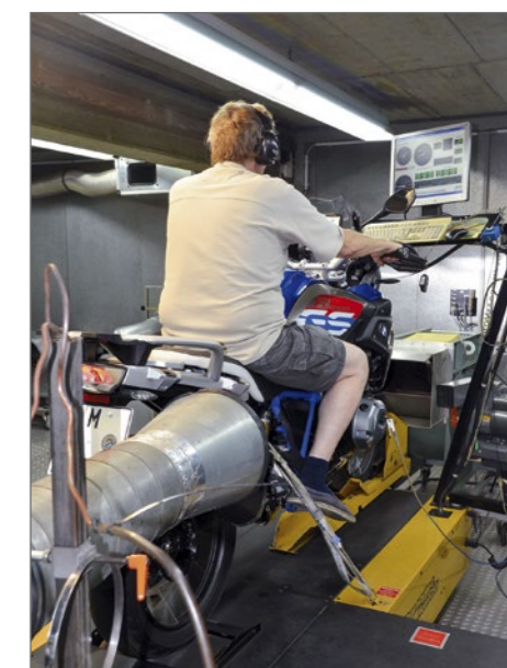
Auf dem Rollenprüfstand wurden Leistung und Drehmoment aller Slip-on-Anlagen ermittelt.
