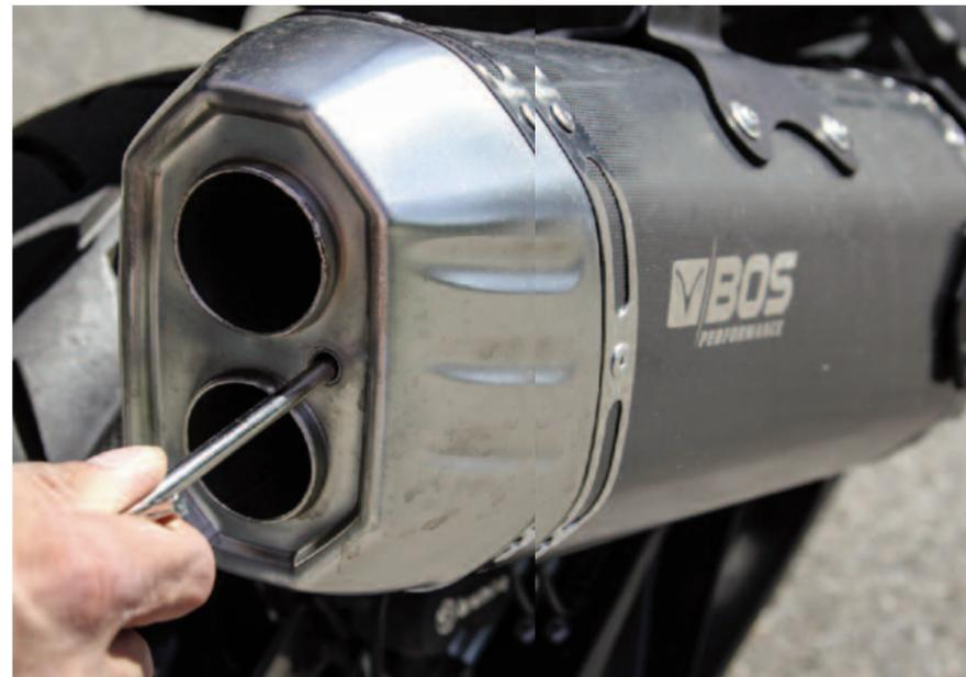
Über eine mechanisch einstellbare Klappe kann die Klangfarbe geregelt werden
