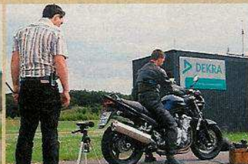
Fahrgeräuschmessung mit Radarüberwachung; Standgeräuschmessung mit Drehzahlkontrollgerät; Leistungsmessung auf dem Rollenprüfstand
