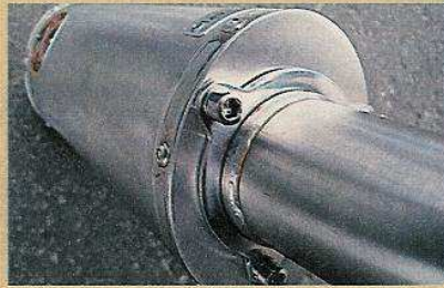
Einziges Bolt-On-Dämpfer im Test: der Ixil mit geschraubtem Endtopf
