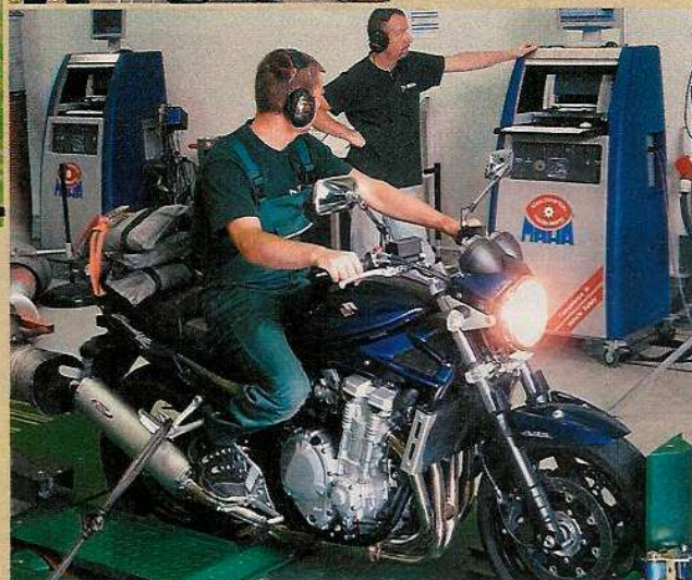
Fahrgeräuschmessung mit Radarüberwachung; Standgeräuschmessung mit Drehzahlkontrollgerät; Leistungsmessung auf dem Rollenprüfstand
